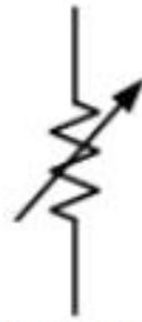
Variable Resistor (Rheostat)
